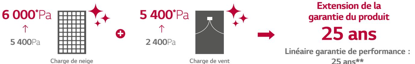
\* Les modules répondent aux exigences de la nouvelle version de la norme IEC 61215 : 2016 qui confirme 5 400Pa en face avant et 4 000Pa en face arrière. LG a réalisé des tests internes et confirme 6 000Pa/5 400Pa. \*\* 1) 1ère année : 98,5 % 2) Après la 2ème année : 0,33 % dégradation annuelle. 3) 90,6 % après 25 ans.
